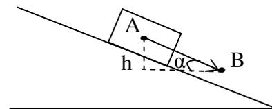
La somme des travaux des force appliquées à ce solide animé d'un mouvement de translation rectiligne uniforme est nulle :
