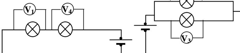
Les voltmètres mesurent les tensions aux bornes des lampes !
