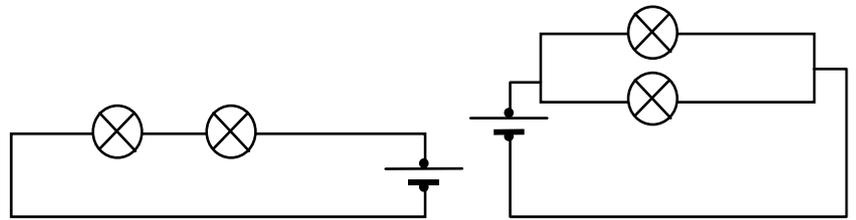
Luc a mesuré les tensions aux bornes des lampes des 2 montages ci-contre, avec des voltmètres notés :  $V_1, V_2, V_3, V_4$ . Sachant que les lampes ne sont pas obligatoirement identiques, que les tensions trouvées sont respectivement :  $U_1 = 4 \text{ V}, U_2 = 12 \text{ V}, U_3 = 12 \text{ V}, U_4 = 8 \text{ V}$  et que les générateurs sont des batteries de  $12 \text{ V}$ , place ces 4 appareils au bon endroit.
